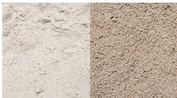
Figuur 3: Dit figuur toont de foto's van de twee verschillende texturen met 210 \mu m links en 300 \mu m rechts. Beide texturen zijn vermengd met 20 procent turf.
