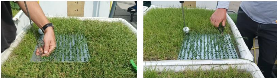
Figuur 5: Links een foto van het innaaiproces met behulp van speciaal gereedschap en rechts het afknippen van de ingenaaide vezels op de juiste hoogte.
