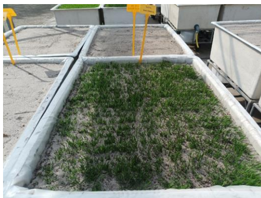
Figuur 6: Foto van een bak met een hybride-mat na het instrooien van het zand.
